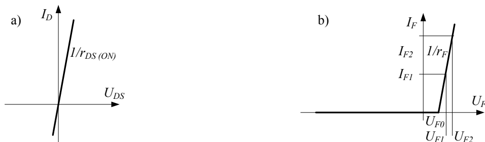
Rys.1. Liniowe aproksymacje charakterystyk a) tranzystora MOSFET w stanie załączenia, b) diody półprzewodnikowej
